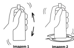
**Atenção:** Evite **agitar em excesso** utilizando movimento de cima para baixo, esse tipo de movimento pode fazer com que a esfera danifique a válvula interna, inutilizando todo o produto.
